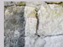
Prova di pulitura con alghicida e lavaggio ad acqua nebulizzata
