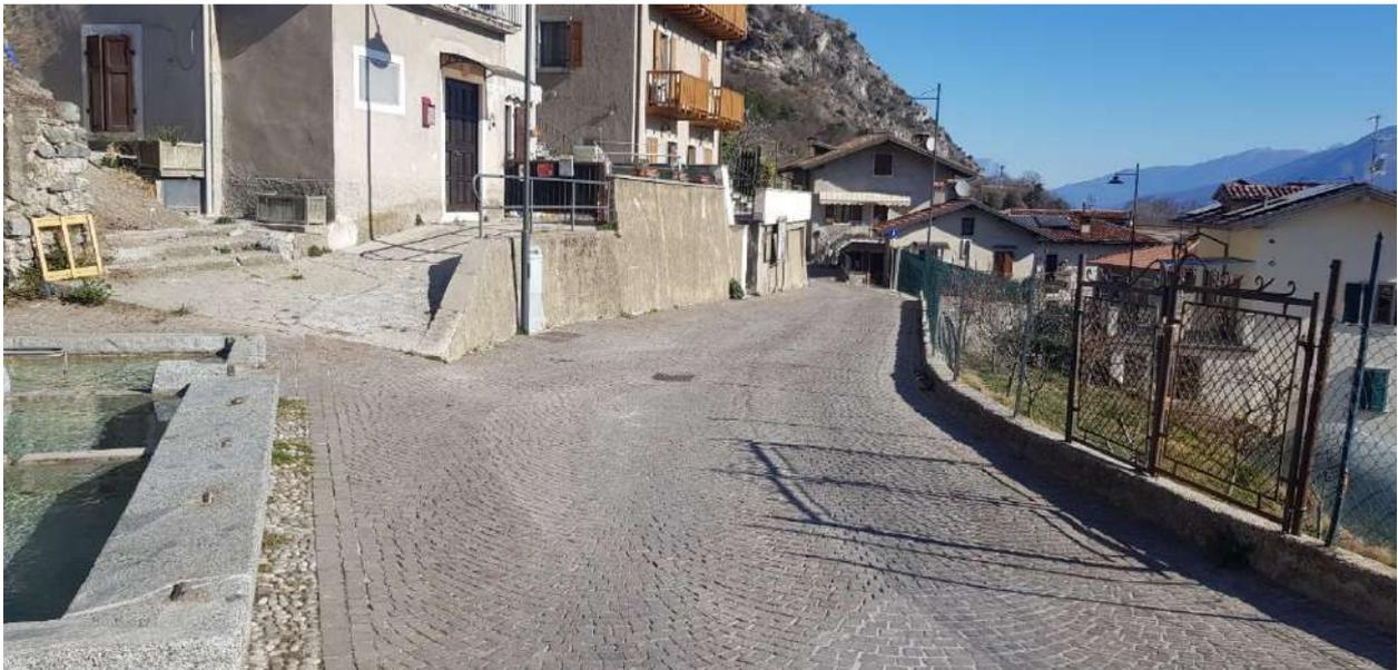
*Figura 10: Si nota come la via di deflusso A non trovi una via preferenziale e con tutta probabilità si disperda tra sede stradale, orti, giardini e campi, probabilmente smaltendosi anche attraverso la rete di collettamento delle acque meteoriche pubblica.*
