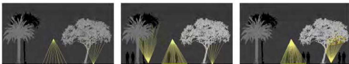
Schematizzazione del sistema Light on Demand per le aree pedonali
