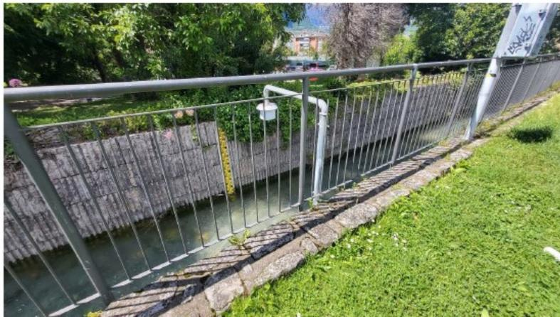
FOTO 22. Torrente Albola. Stazione idrometrica e di rilevamento della portata
