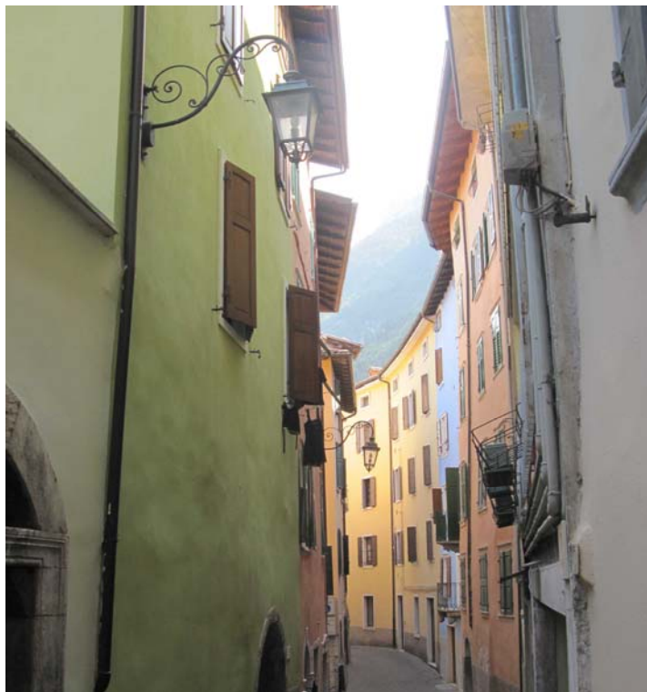
Apparecchi decorativi tipo lanterna diffondente installati in Via Marocco, classificabili come apparecchi di classe E ai sensi dell'Allegato C al Piano provinciale.
