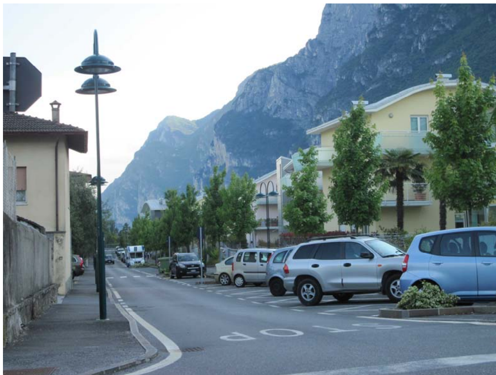
Apparecchi decorativi totalmente schermati installati in Via Giovanni Pascoli, classificabili come apparecchi di classe A ai sensi dell'Allegato C al Piano provinciale.
