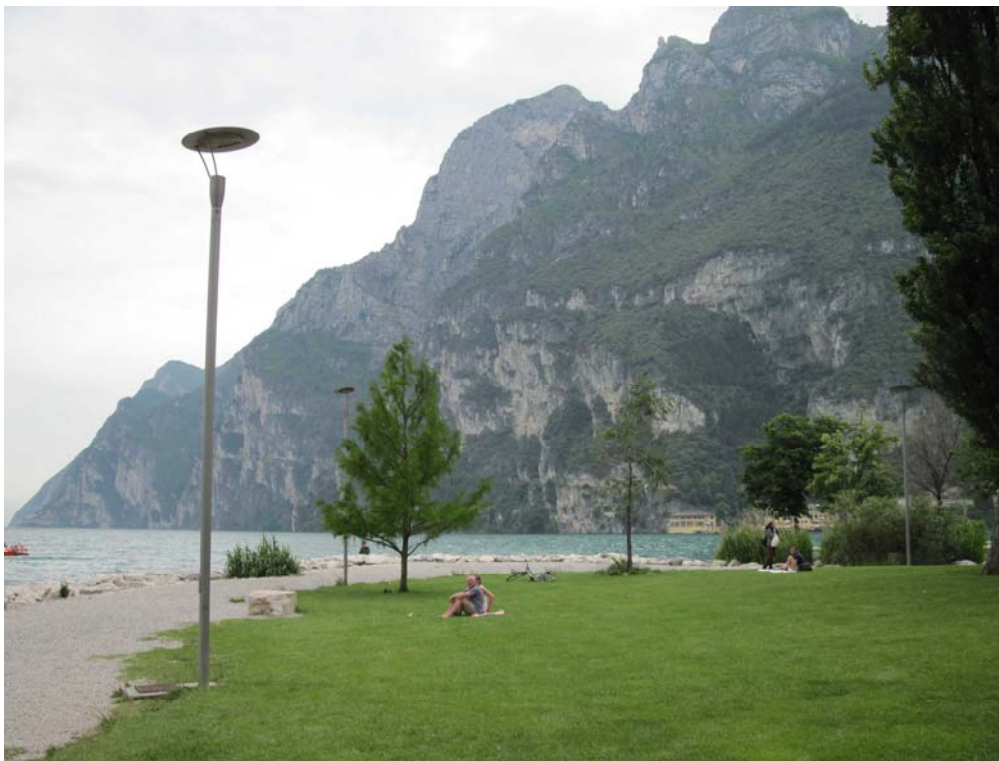
Apparecchi decorativi di tipo diffondente installati sul Lungolago di Parco Miralago, classificabili come apparecchi di classe C ai sensi dell'Allegato C al Piano provinciale.
