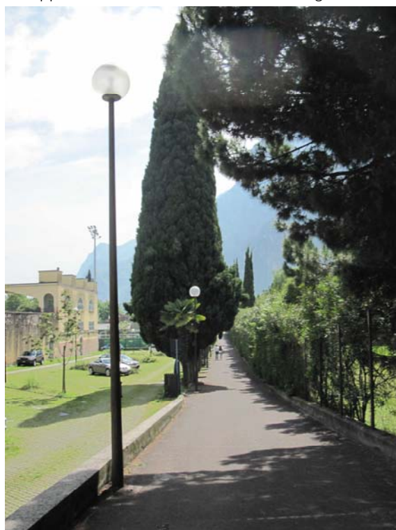
Apparecchi di arredo urbano di tipo diffondente installati in via Cristoph Hartung Von Hartungen, classificabili come apparecchi di classe E ai sensi dell'Allegato C al Piano provinciale.
