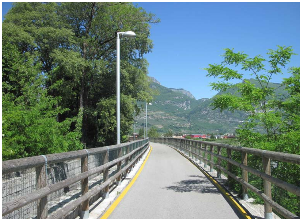
Apparecchi decorativi totalmente schermati installati lungo la ciclopedonale Torrente Varone, classificabili come apparecchi di classe A ai sensi dell'Allegato C al Piano provinciale.
