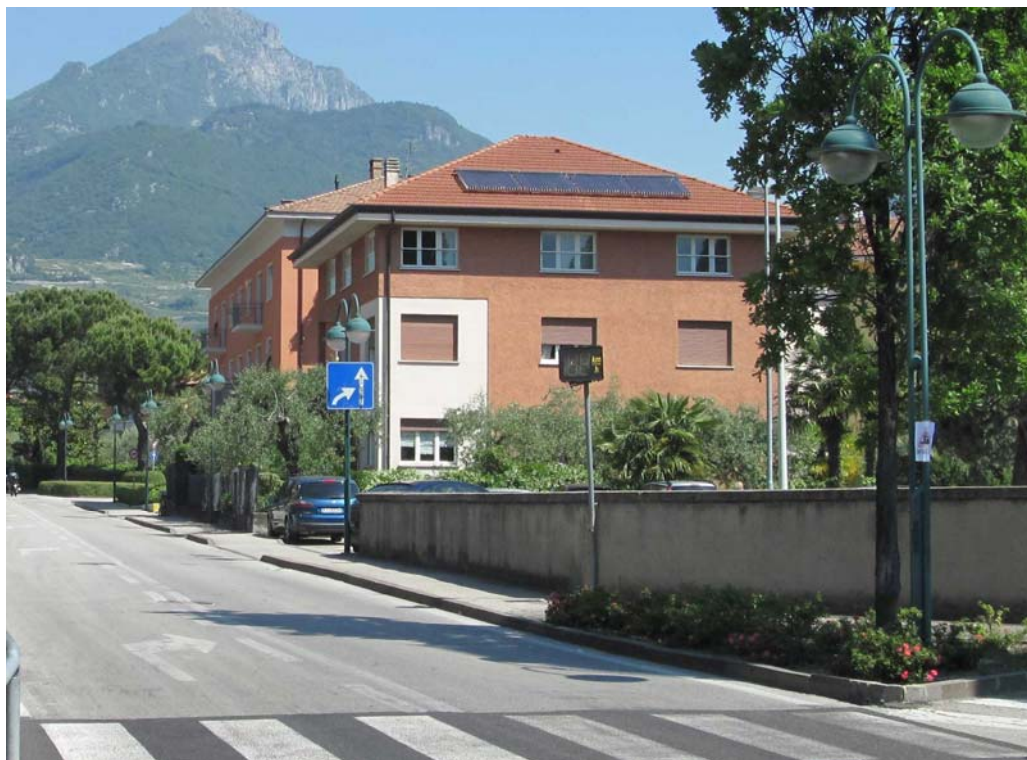
Apparecchi decorativi di tipo diffondente installati in Via Riccamboni, classificabili come apparecchi di classe B ai sensi dell'Allegato C al Piano provinciale.
